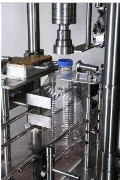
Рис. 2 Патрон с магнитной головой
